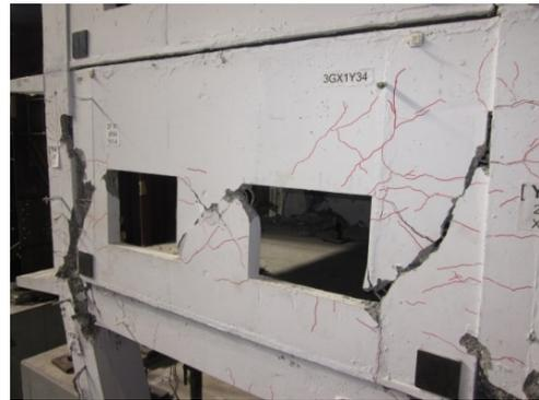
耐震スリットの接触による雑壁や間柱の損傷（2階妻面）
