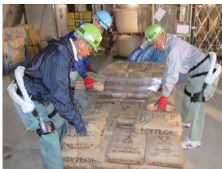
HAL®を装着して、セメント袋(25kg/袋)を運ぶ建設技能労働者
