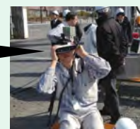
ヘッドマウントディスプレイを通すと 施工中の現場に竣工時の建物が 浮かび上がる
