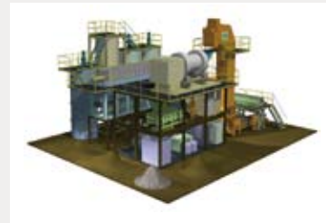
重金属による汚染土壌を敷地内で浄化する「アールキュービックMINI土壌洗浄システム」
