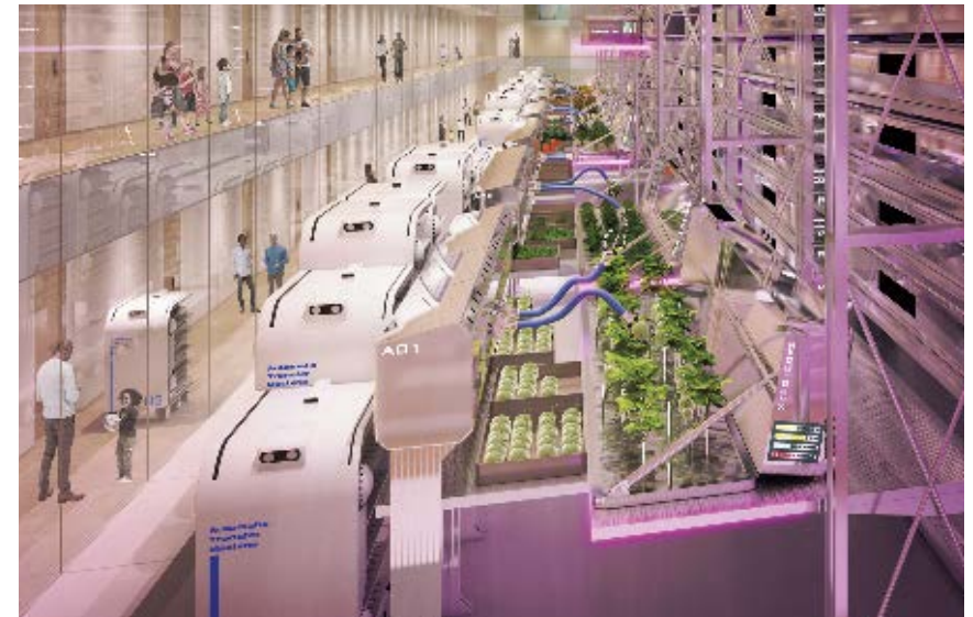
ロボットの前に自走してきたモジュールはカバーを開いて、ロボットのアームによって手入れや収穫が行われる。収穫時には可動式パレットごとロボットの背後のコンテナに搭載し、配送センターへと自動搬送される
