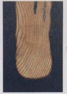
大きい断面の木材は、表面は燃えても内部はしっかりと残っている。(黒い部分が炭化層)写真/朝日住宅・木材技術センター
