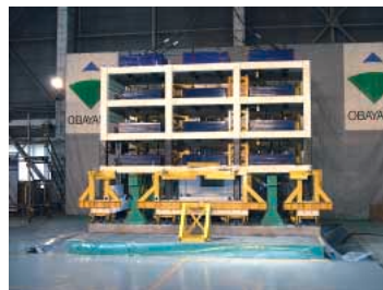
振動台により建物を破損させる
