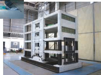
破損させた建物を補強し、再度揺れを加えても建物は倒壊しなかった
