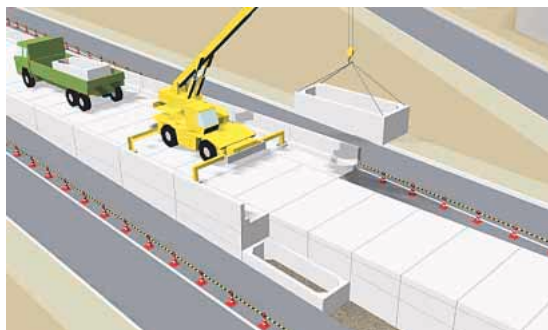
OK-PASS工法でアプローチ部を構築
