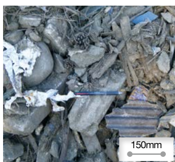
コンクリートがら、木材、ゴム、金属類、土石、プラスチック、瓦などが混入 (粒径25～150mm)
