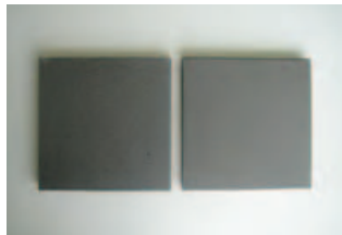
再生骨材製造時に発生する微粉を使用した陶磁器タイル(左写真建物の床に使用)
