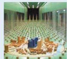
風洞実験施設
